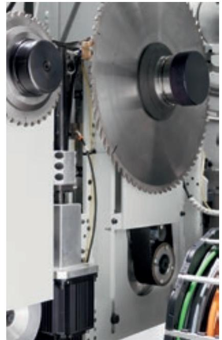
La subida motorizada de las sierras garantiza una **regulación precisa y rápida** del saliente de la sierra.
