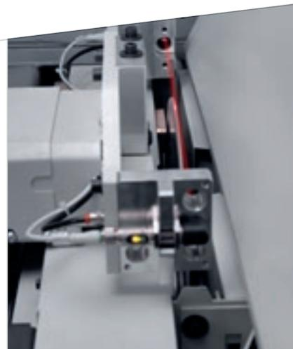
**Alineación automática del incisor.** El sistema patentado es capaz de alinear automáticamente el incisor con la nueva sierra en unos pocos segundos. Permite reducir los tiempos de colocación de las herramientas, los cortes de prueba y la posibilidad de error con un aumento de la productividad y una reducción de los costes de gestión del afilado.
